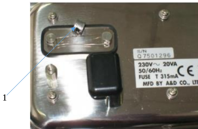
Рисунок 2 – Схема пломбировки (1 – свинцовая пломба)
