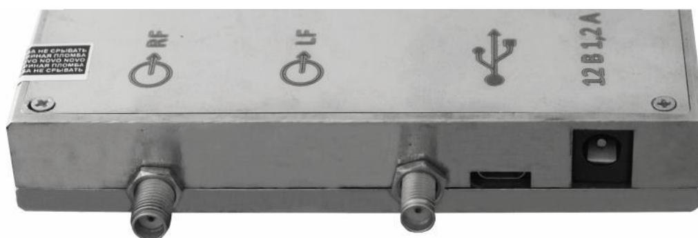
Рисунок 3 – Вид задней панели генератора
