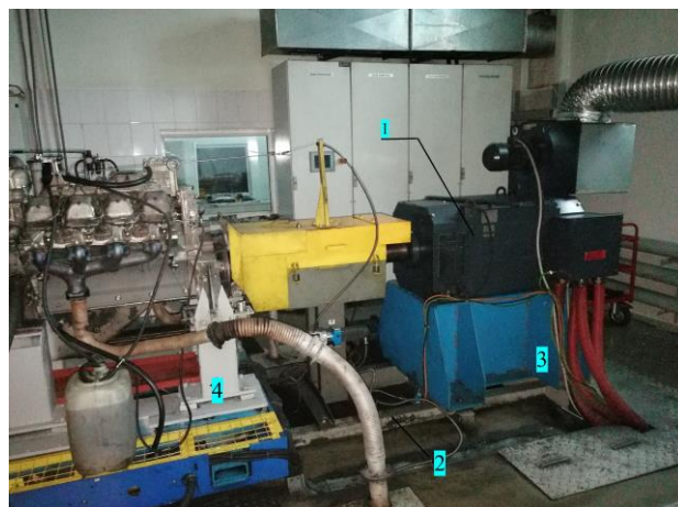
Рисунок 2 – Асинхронная машина со встроенным датчиком скорости и вентилятором охлаждения (1 – электрическая машина, 2 – рама комплекса, 3 – подставка под электрическую машину, 4 – рама для установки ДВС)
