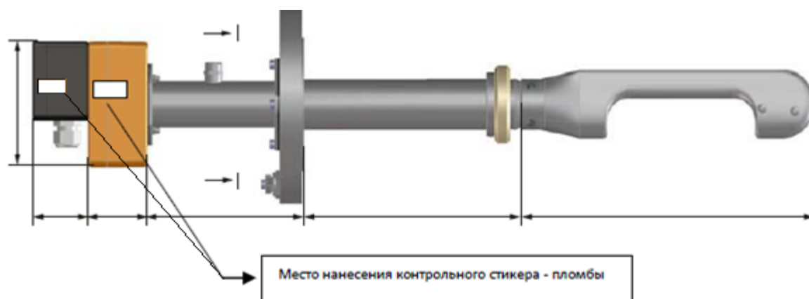
Рисунок 3 – Схема пломбирования. Приемопередающий блок.
