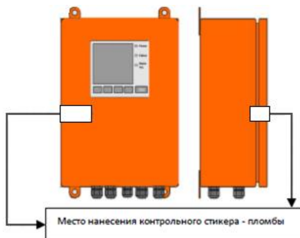
Рисунок 2 – Схема пломбирования. Блок электроники.
