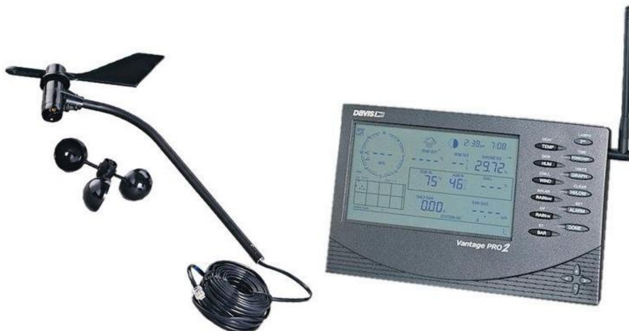
Рисунок 2 – Общий вид первичного преобразователя скорости и направления воздушного потока (слева) и модуля центрального устройства (справа)
