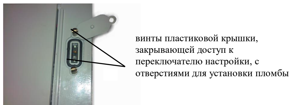
Рисунок 3 - Схема пломбировки весов от несанкционированного доступа. Пломбировка переключателя настройки
