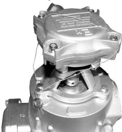
Рисунок 9 – Пломбирование генератора импульсов
