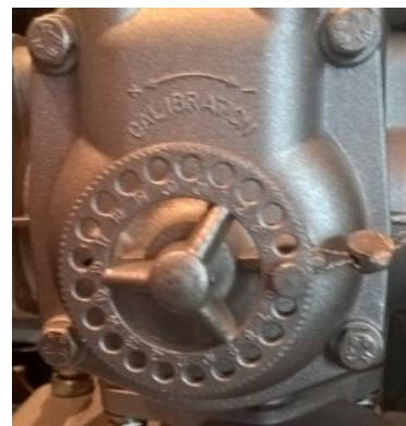
Рисунок 8 – Пломбирование счётчика жидкости объёмного типа RSJ
