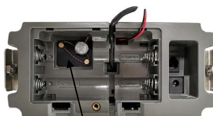
Рисунок - 5 Схема пломбировки от несанкционированного доступа и обозначение места для нанесения оттиска клейма
