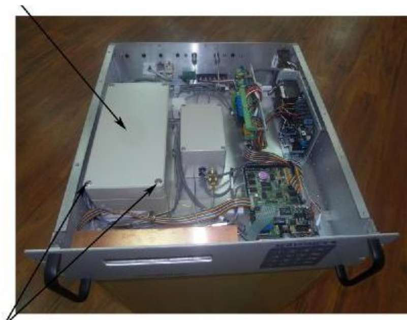
Рисунок 2 – Место пломбирования измерительной ячейки
