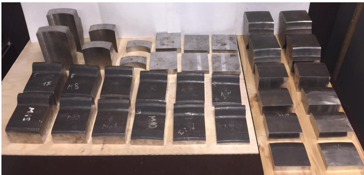
Рисунок 1 - Общий вид комплекта мер неразрушающего контроля для настройки предельной чувствительности ультразвукового контроля цельнокатаных колёс КМ НК
