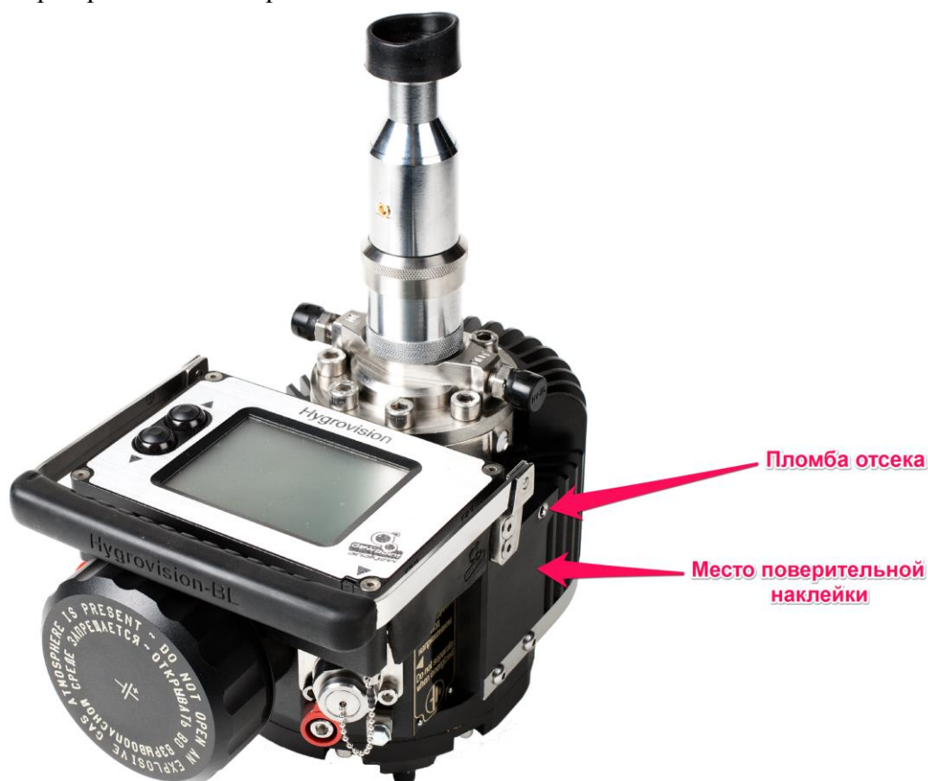
Рисунок 1 - Внешний вид анализатора точки росы «Hygrovision-BL»
