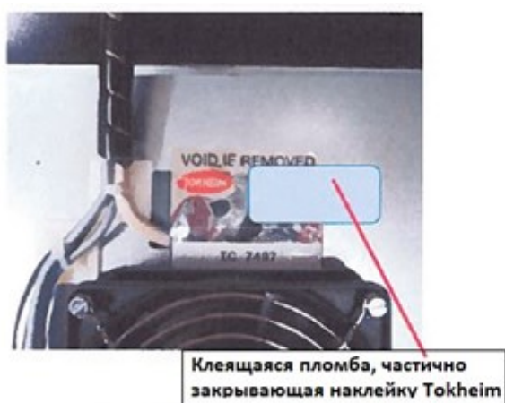
пломба информационного кабеля на дисплее VGA, способ 1
