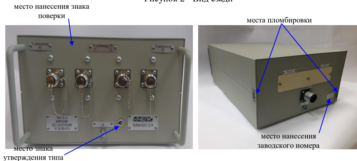
Рисунок 3 - Схема пломбировки, обозначение места нанесения знака поверки и заводского номера
