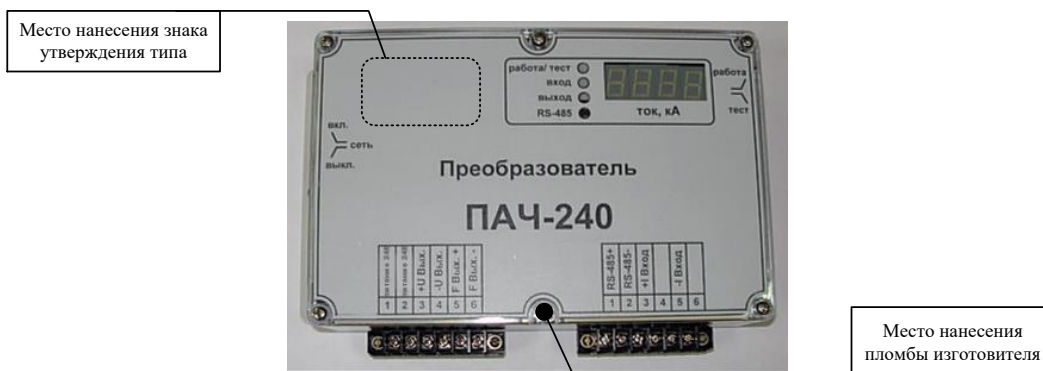
Рисунок 1 – Общий вид преобразователей и схема пломбировки преобразователей от несанкционированного доступа
