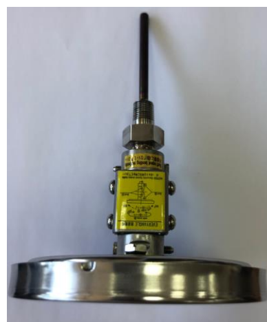
Рисунок 1 – Общий вид термометра биметаллического «A FLOW» с указанием места нанесения заводского номера
