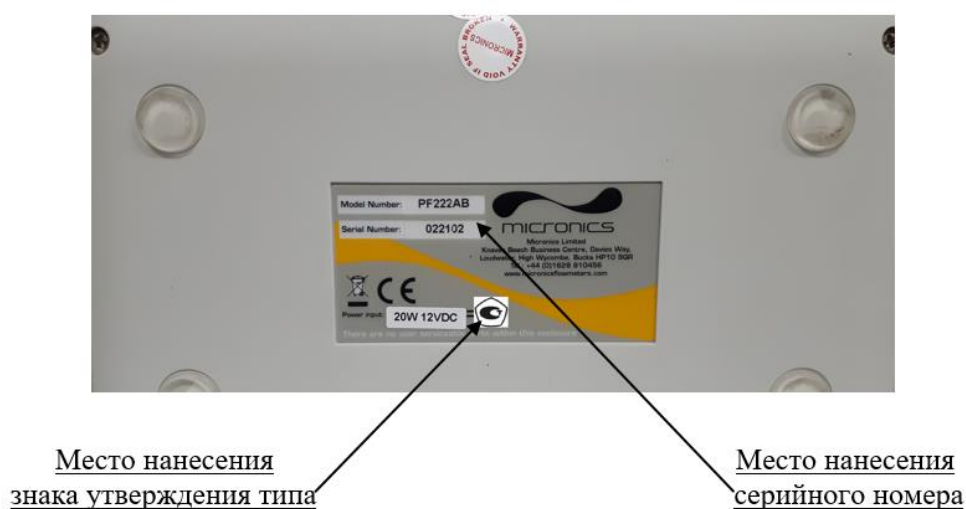
Рисунок 5 – Места нанесения знака утверждения типа и серийного номера на расходомеры модификаций PF222 и PF333
