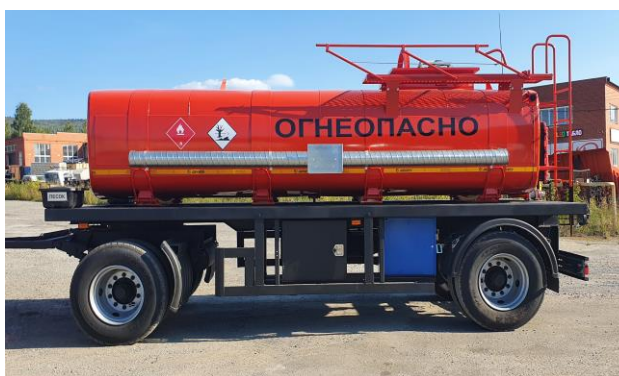
Рисунок 1 – Общий вид ПЦ с одной секцией
