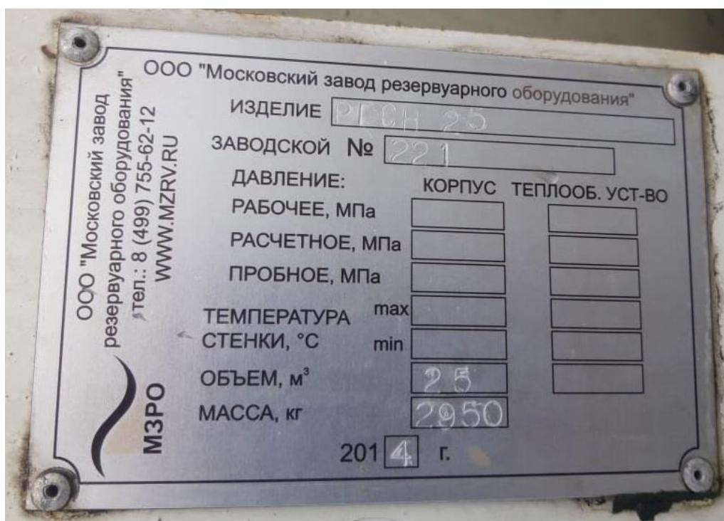
Рисунок 3 – Маркировочная табличка резервуара РГС-25, зав.№221
