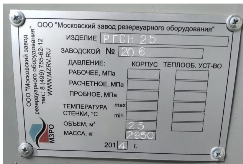
Рисунок 10 – Маркировочная табличка резервуара РГС-25, зав.№206
