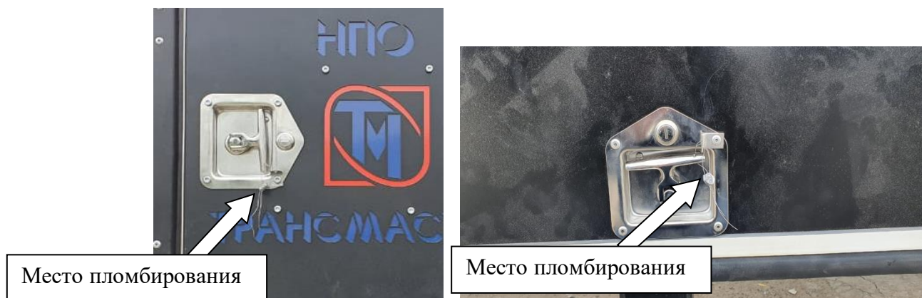
Рисунок 5 – Замок отсека узла выдачи топлива и замок технического отсека
