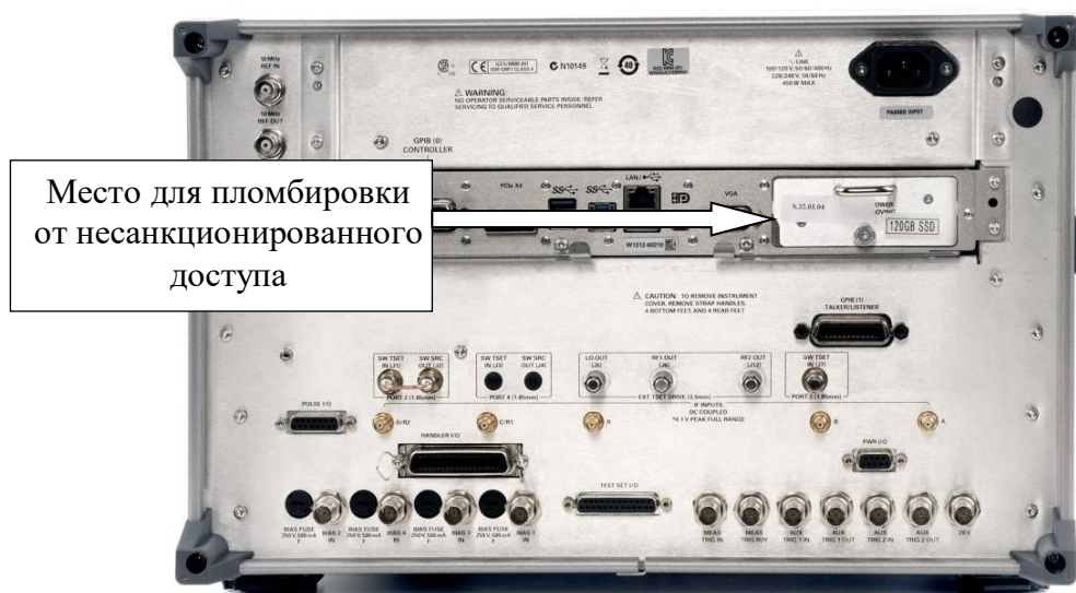
Рисунок 10 – Задняя панель ВАЦ с указанием места пломбировки от несанкционированного доступа
