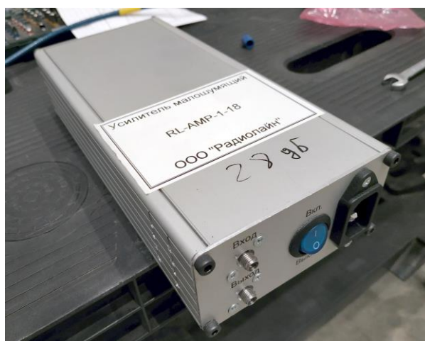
Рисунок 6 – Общий вид МШУ
