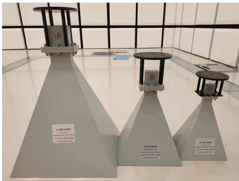
Рисунок 5 – Комплект антенн, предназначенных для измерения коэффициента усиления
