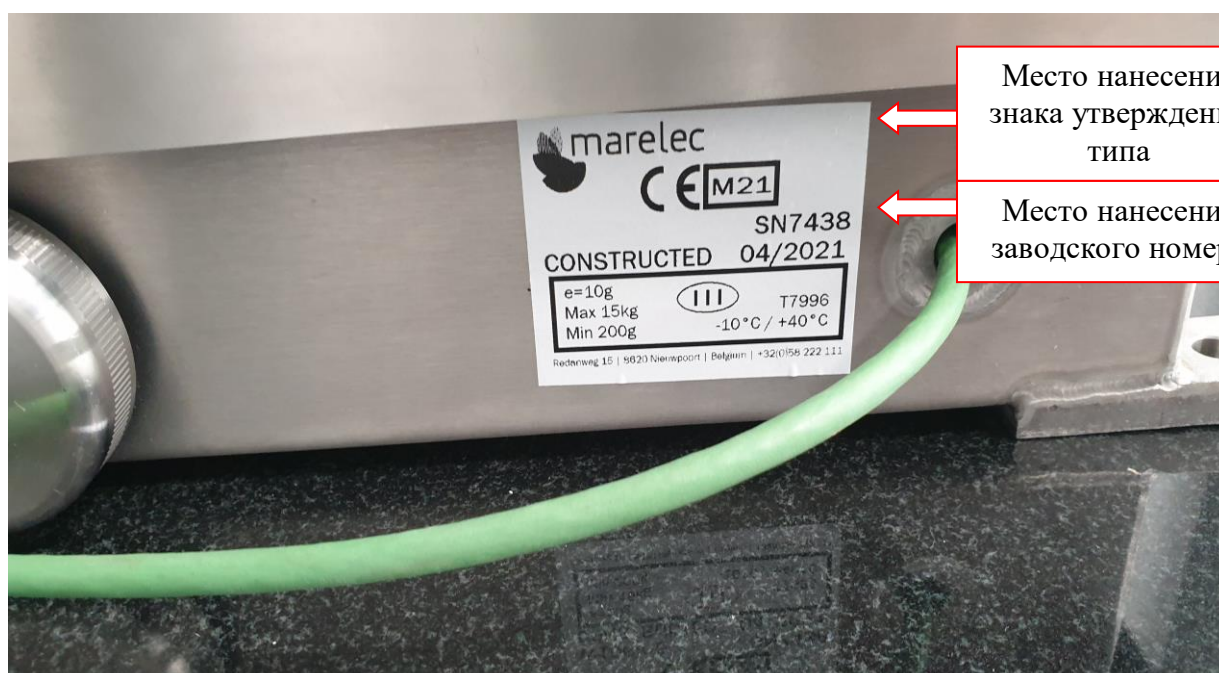
Рисунок 3 – Место несения заводского номера и знака утверждения типа
