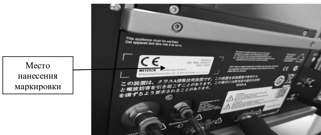
Рисунок 2 – Маркировка реометров Kinexus
