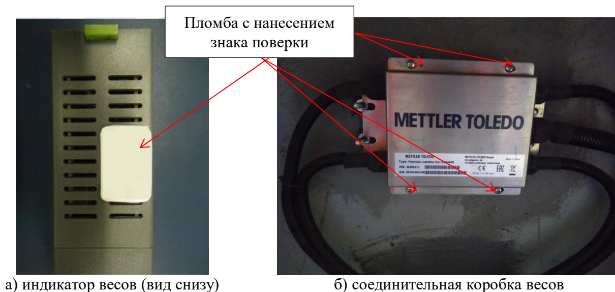
Рисунок 4 - Схема пломбирования весов от несанкционированного доступа к местам настройки (регулировки)
