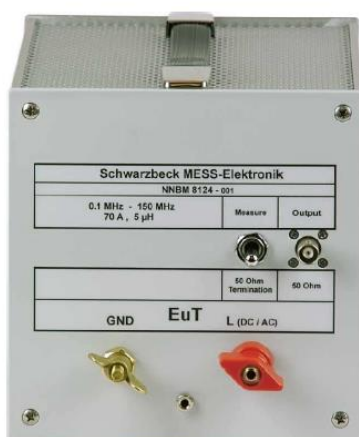
Рисунок 1а - Эквивалент сети NNBM 8124 вид спереди (слева), NNBM 8124 вид сзади (справа)
