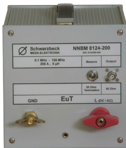
Рисунок 1б - Эквивалент сети NNBM 8124-200 вид спереди (слева), NNBM 8124-200 вид сзади (справа)
