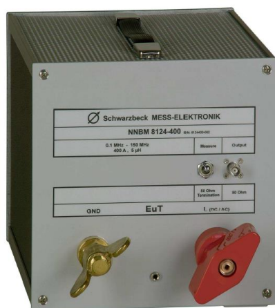
Рисунок 1в - Эквивалент сети NNBM 8124-400 вид спереди (слева), NNBM 8124-400 вид сзади (справа)
