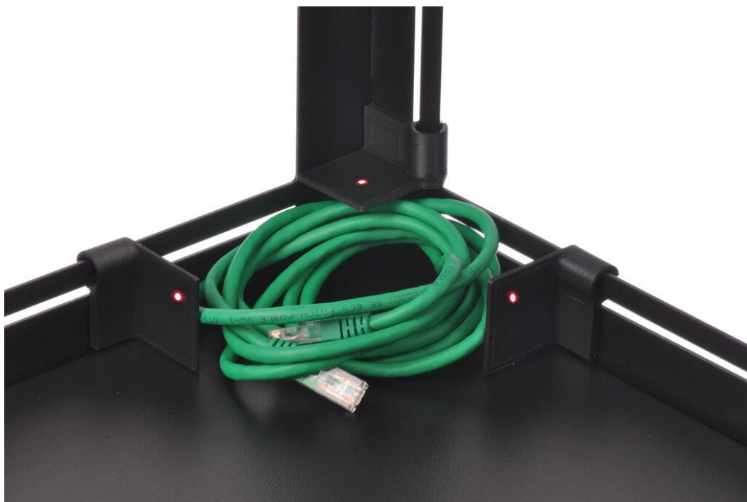
Рисунок 2 – Пример измерения габаритных размеров объекта неправильной формы
