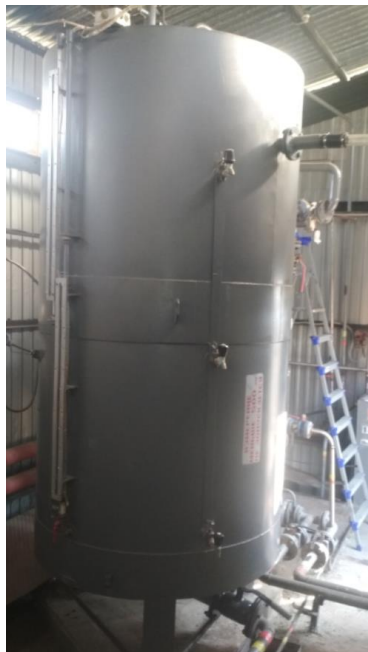
Рисунок 1 - Общий вид мерника технического 1-го класса М1кл-2500, зав.№ 1
