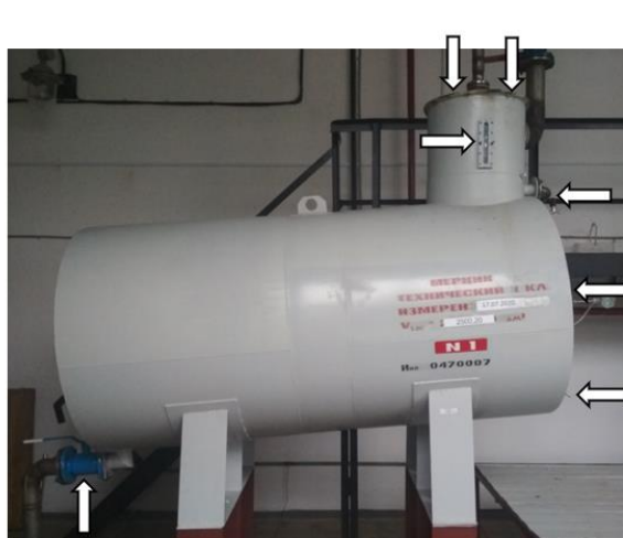
Рисунок 2 – Схема пломбировки мерников технических 1-го класса М1кл-2500Н, зав.№№ 1, 2 от несанкционированного доступа, обозначение места нанесения знака поверки
