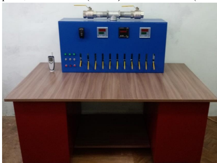
Рисунок 3 – Общий вид установок поверочных для счетчиков газа «УПСГ-КС» модификаций «УПСГ-КС-(65...160)-Р» и «УПСГ-КС-(65...160)-А»
