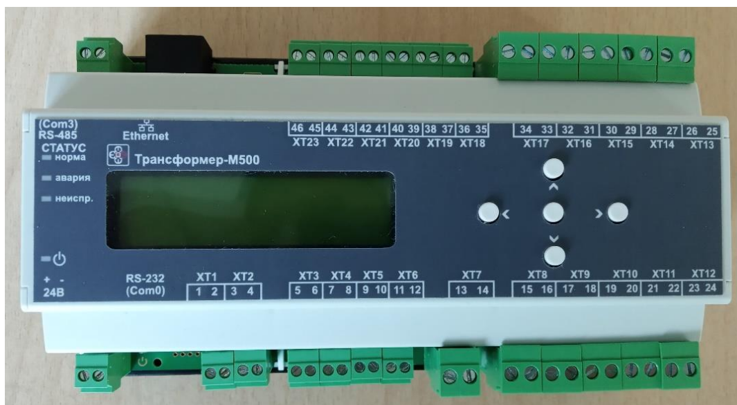
Рисунок 1 – Общий вид контроллеров промышленных Трансформер-M500
