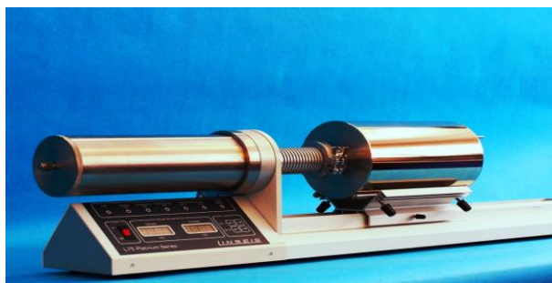
Рисунок 1 – Общий вид измерительного блока дилатометра с толкателем L – series модификации L75H
