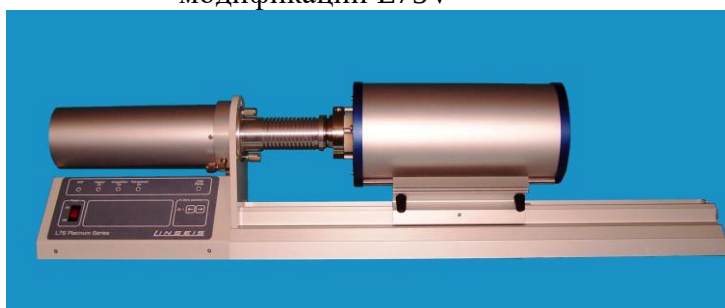
Рисунок 3 – Общий вид измерительного блока дилатометра с толкателем L – series модификации L76
