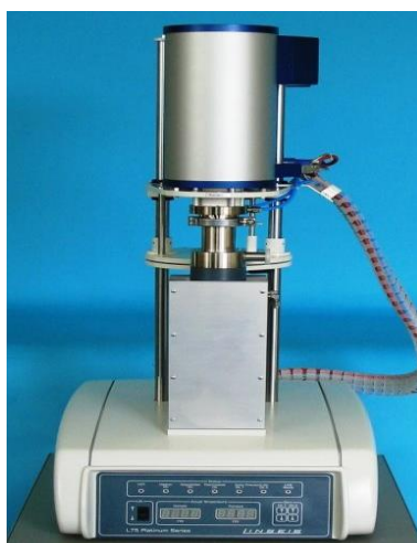
Рисунок 2 – Общий вид измерительного блока дилатометра с толкателем L – series модификации L75V
