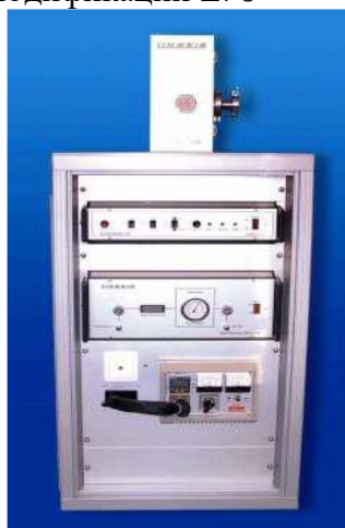
Рисунок 4 – Общий вид измерительного блока дилатометра с толкателем L – series модификации L78/RITA
