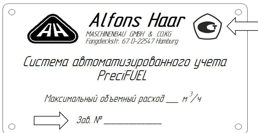
Рисунок 3 – Места нанесения знака утверждения типа и заводского номера
