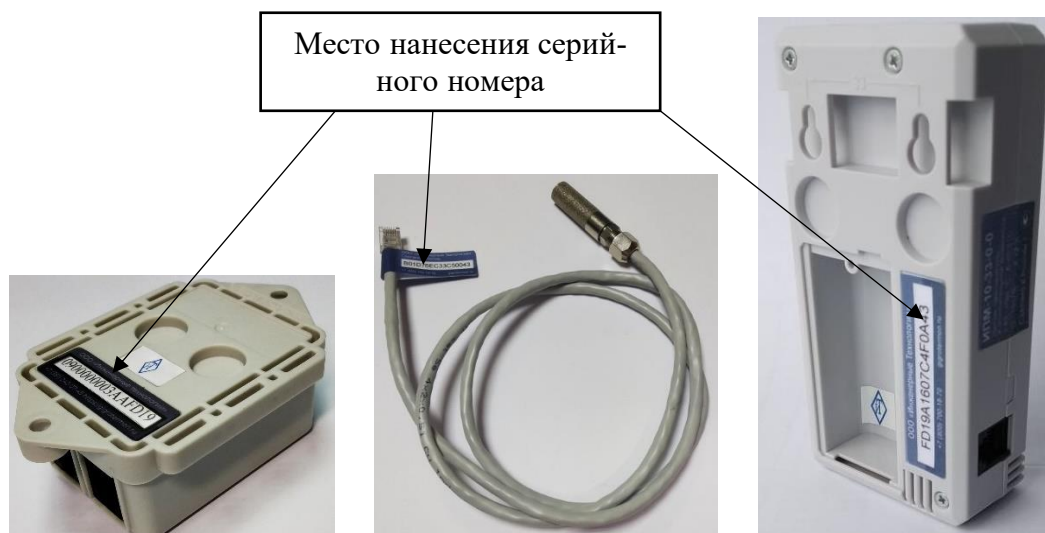
Рисунок 3 – Место нанесения серийного номера
