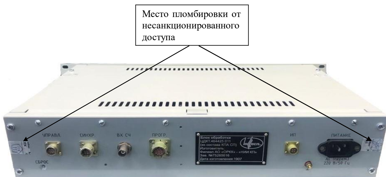
Рисунок 3 – Общий вид задней панели КПА СП
