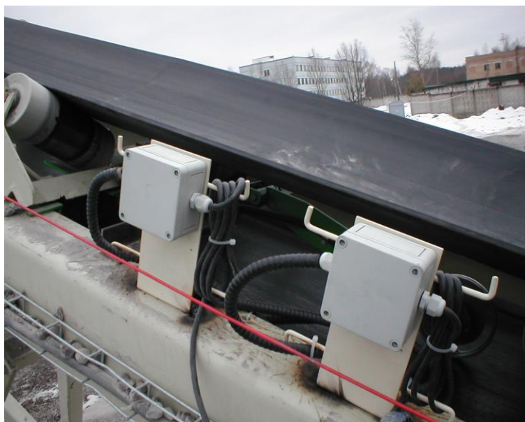
Рисунок 2 - Внешний вид силоприемного устройства с конвейерной лентой
