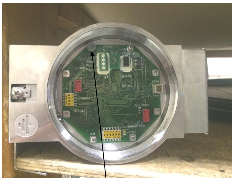
Рисунок 2 - Схема пломбировки от несанкционированного доступа
