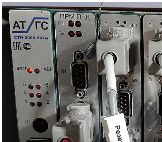
Рисунок 3 – Пломбирование платы центрального процессора контроллера
