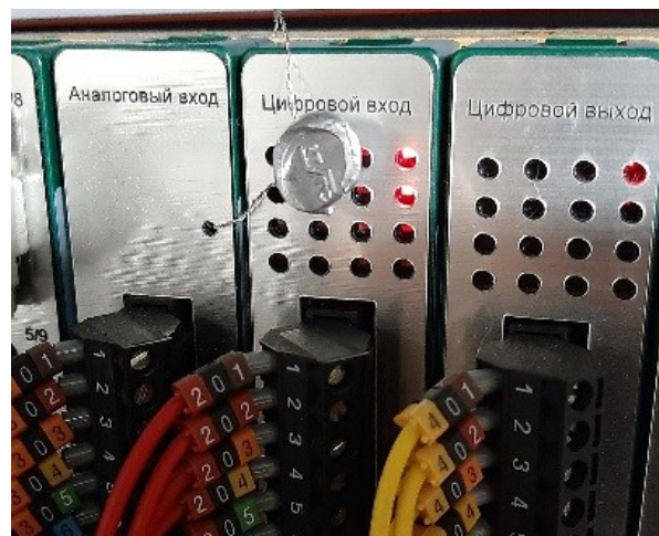
Рисунок 4 – Пломбирование платы аналогового входа контроллера
