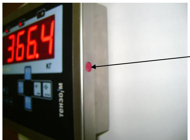
Рисунок 2 - Схема пломбировки преобразователя (мастичная пломба. Знак поверки в виде оттиска поверительного клейма наносится на пломбу)
