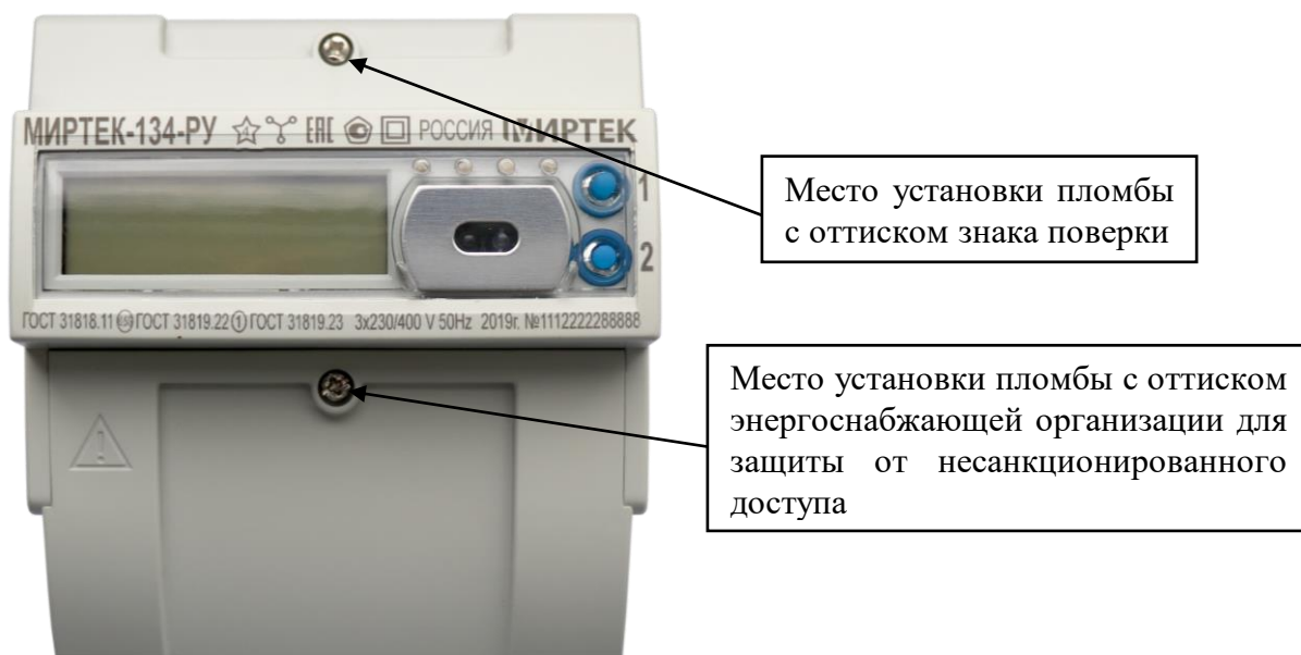
Рисунок 2 – Общий вид измерителя в корпусном исполнении D33.1
