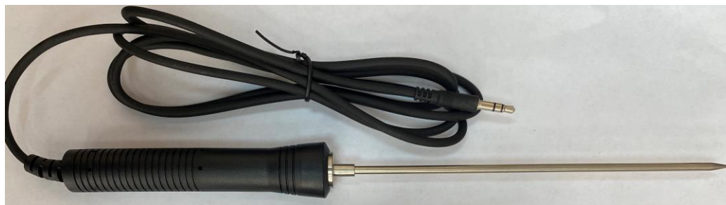
Рисунок 3 – Общий вид температурного зонда PR1
