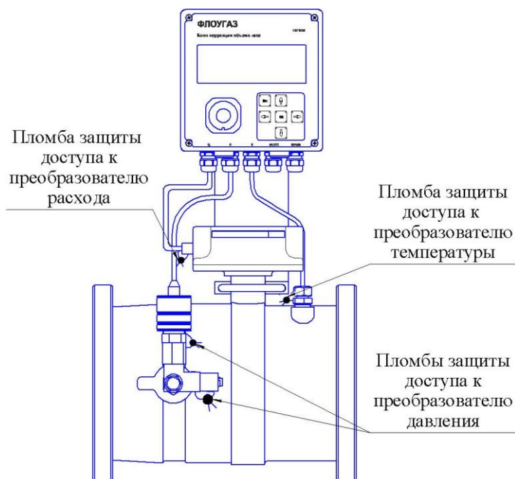
Рисунок 2 – Схема пломбировки комплекса
