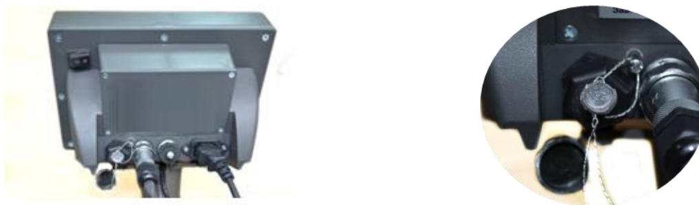
Рисунок 3 – Схема пломбировки приборов ТИТАН 12, обозначение мест нанесения знака поверки
