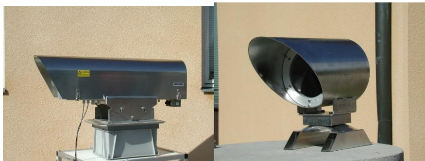
Рисунок 6 – Приёмопередатчик и отражатель для измерения загрязняющих веществ в атмосферном воздухе с помощью газоанализатора LD500
