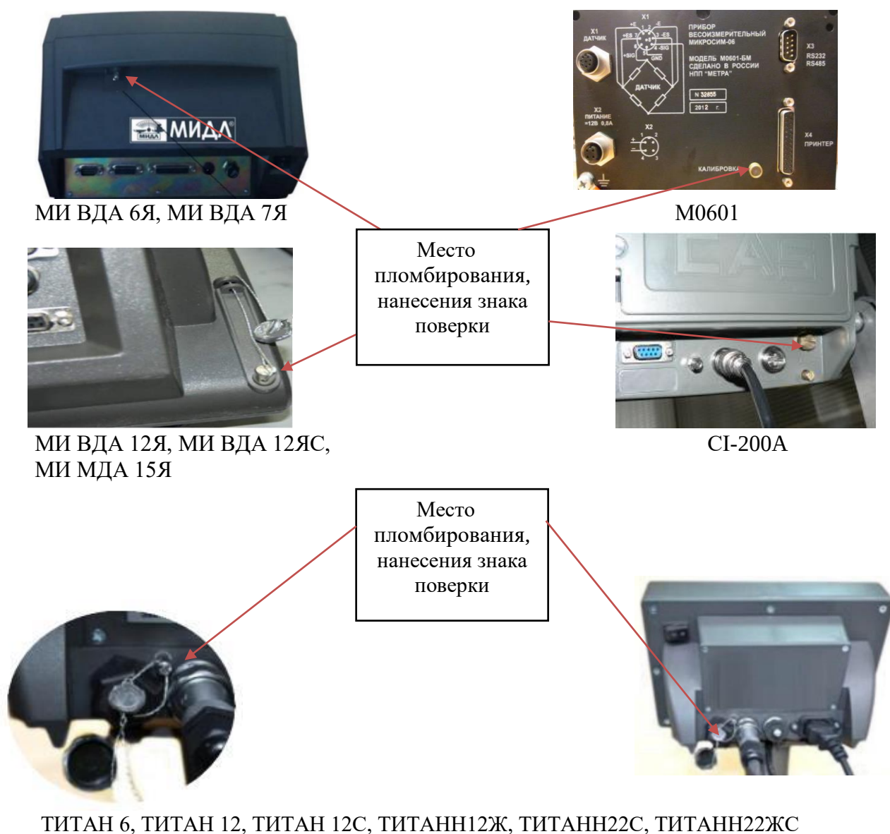
Рисунок 3 – Схема пломбировки от несанкционированного доступа, место нанесения знака поверки для весов
