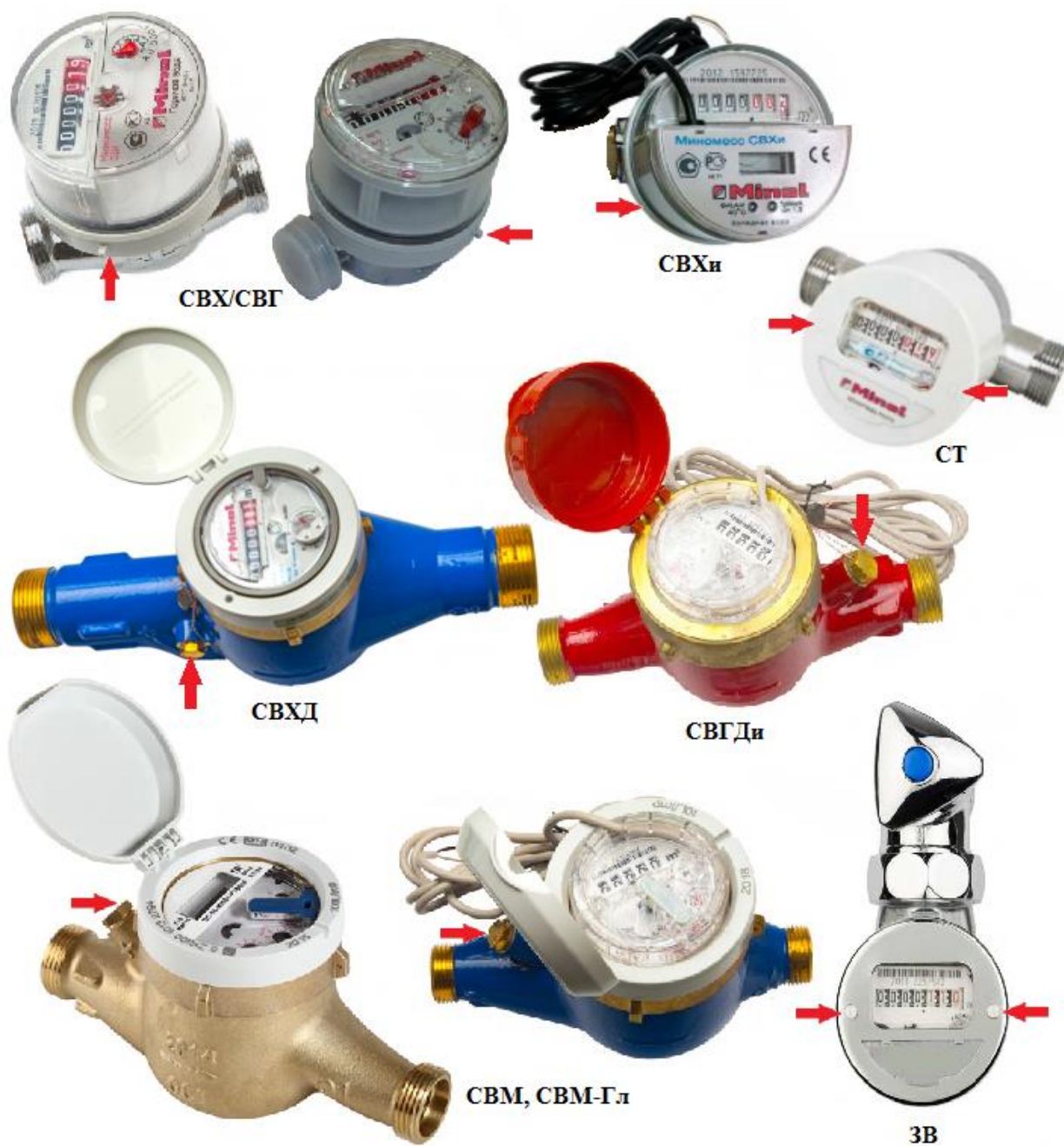
Рисунок 1 – Общий вид счётчиков с указанием мест пломбирования
