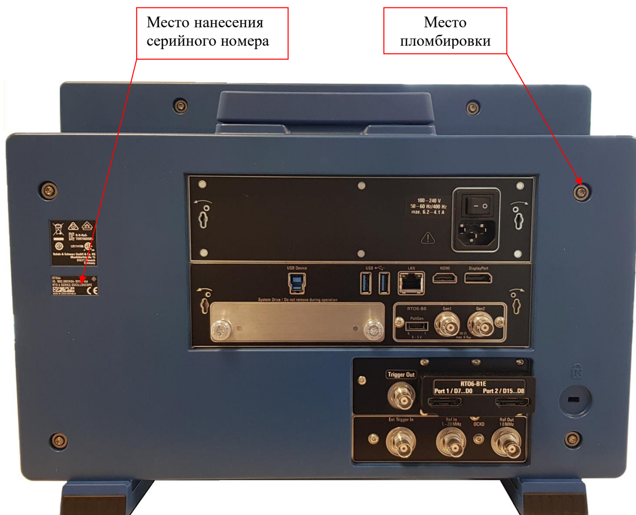
Рисунок 2- Схема пломбировки от несанкционированного доступа и место нанесения серийного номера, идентифицирующего каждый экземпляр СИ
