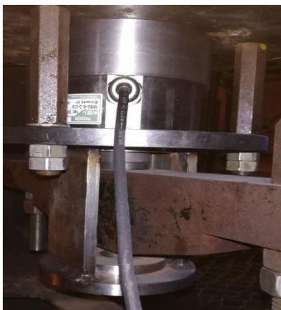
Рисунок 5 – Датчик весоизмерительный тензорезисторный М50-С3. Монтаж по месту
