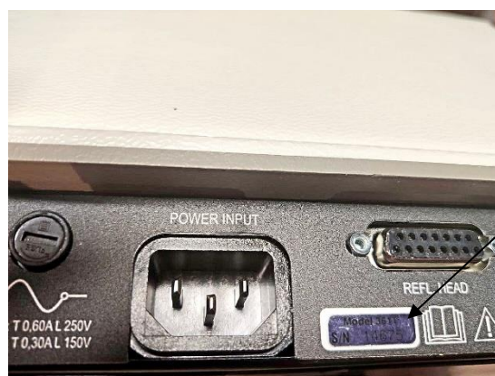
Рисунок 2 – Обозначение места нанесения маркировки и заводского номера
