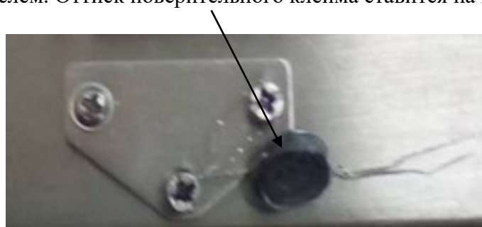
Рисунок 3 – Схема пломбировки от несанкционированного доступа и обозначение места для нанесения оттиска клейма индикатора СТТ-А
