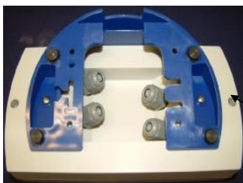
Рисунок 8 – Схема пломбировки от несанкционированного доступа и обозначение места для нанесения оттиска клейма индикатора CTT-DIGITAL
