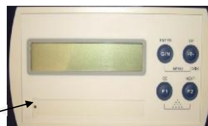
Рисунок 8 – Схема пломбировки от несанкционированного доступа и обозначение места для нанесения оттиска клейма индикатора CTT-DIGITAL
