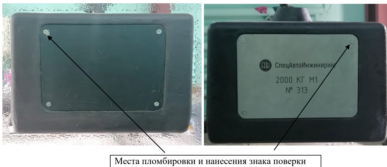
Рисунок 2 – Маркировка, обозначение мест пломбировки и нанесения знака поверки.
