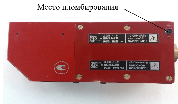
Рисунок 2 – Общий вид датчика ДДИ-1-01 и схема пломбировки от несанкционированного доступа
