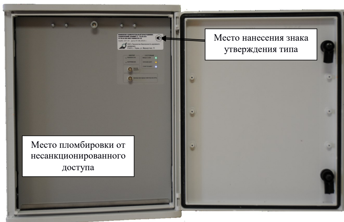
Рисунок 2 – Общий вид вычислительного модуля комплексов в исполнении 01
