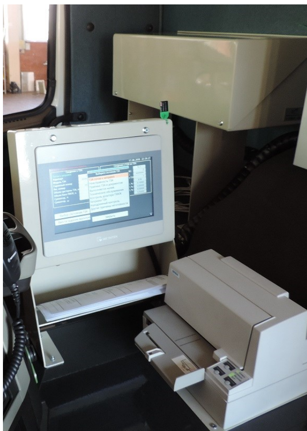
Рисунок 3 – Общий вид составных частей системы (БСК-01 с закрытой защитной крышкой, ТОС-01, принтер) в кабине средства заправки
