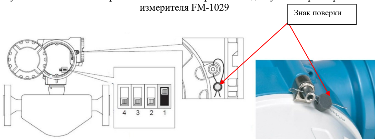
Рисунок 3 – Схема пломбировки от несанкционированного доступа расходомера массового LPGmass
