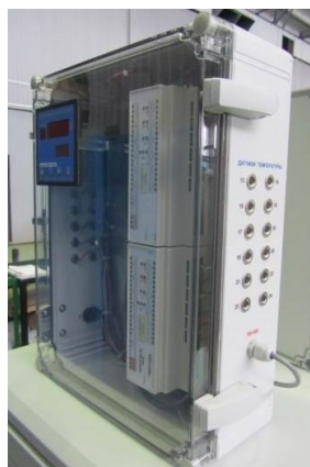
Рисунок 4 – Шкаф измерительный температуры
