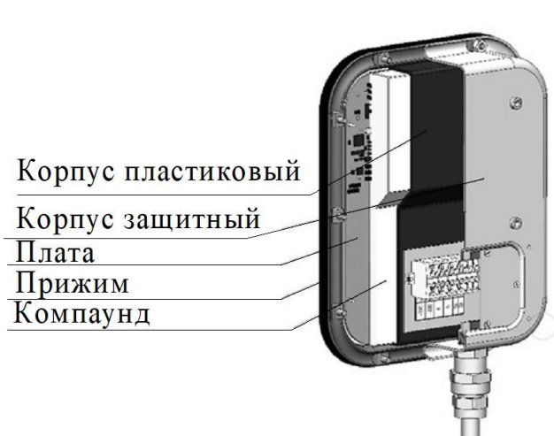
Рисунок 13 – Блок управления БУИ. Схема пломбирования от несанкционированного доступа (посредством заливки компаундом)
