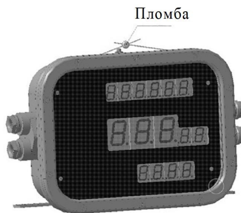
Рисунок 12 – Измеритель объема с овальными шестернями ППО. Схема пломбирования от несанкционированного доступа, обозначение мест нанесения знака поверки
