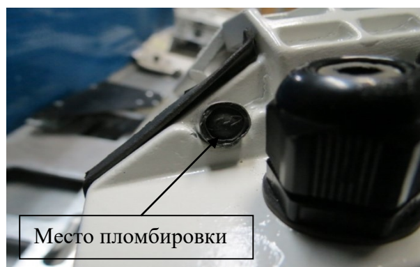
Рисунок 4 – Схема пломбировки видео модуля
