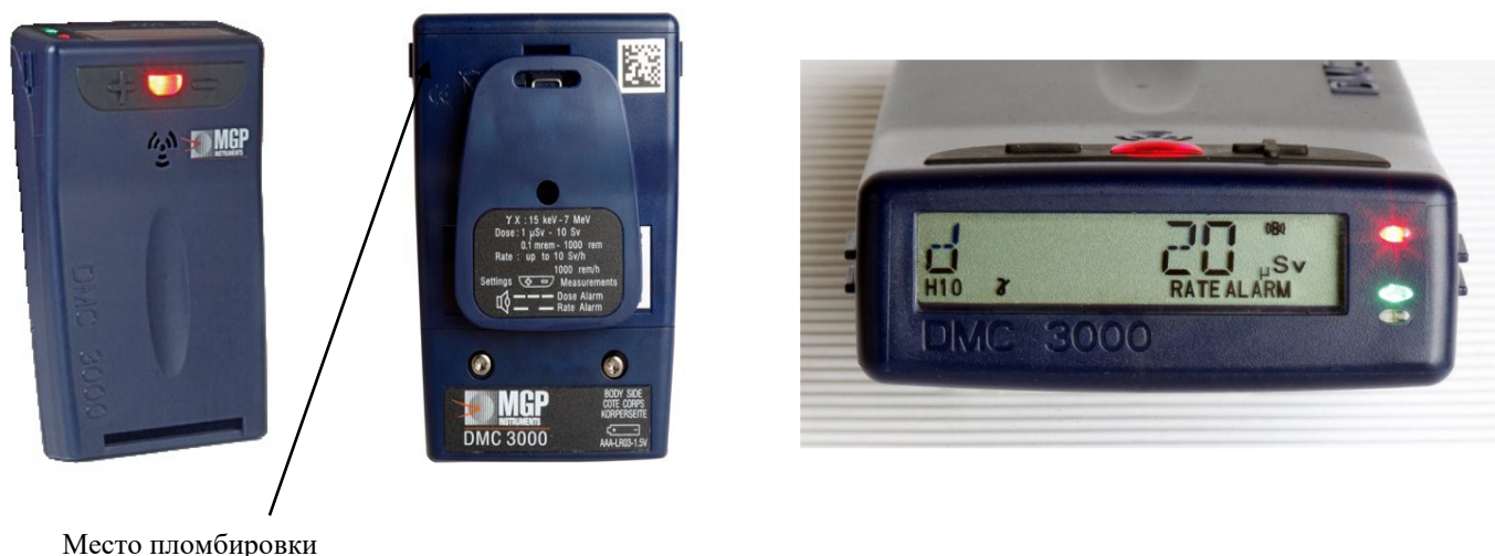
Рисунок 1 – Дозиметр индивидуальный DMC3000
