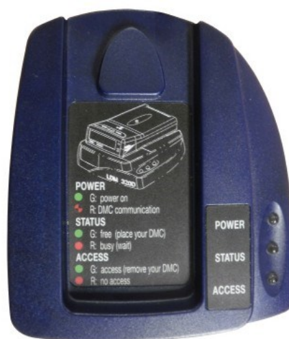
Рисунок 2 – Бесконтактный считыватель LDM 320.
