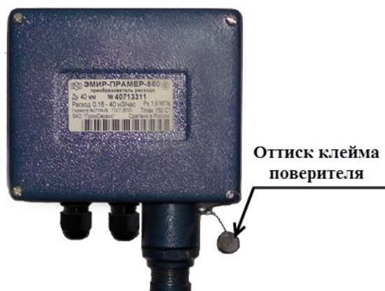
Рисунок 3 – Место пломбирования ЭП в стальном корпусе
