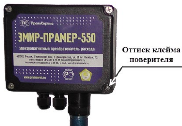
Рисунок 4 – Место пломбирования ЭП в пластиковом корпусе
