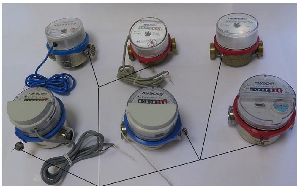
Место пломбирования и нанесения знака поверки
