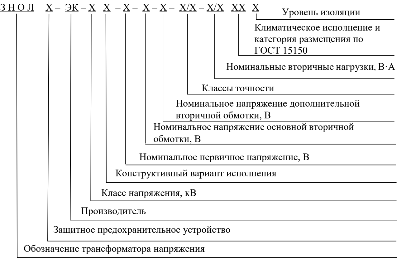
Рисунок 1 – Расшифровка условного обозначения трансформаторов напряжения
