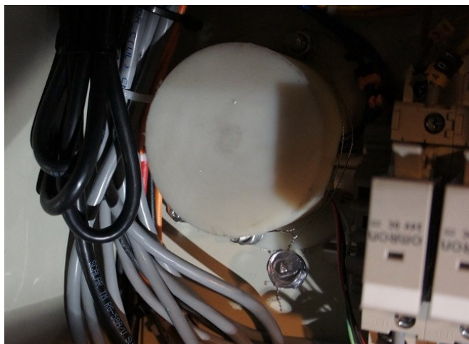
Рисунок 11 – Пломбирование преобразователя температуры PR
