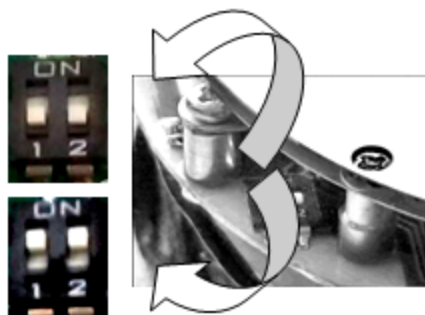
б) расположение переключателя защиты конфигурации счетчика для модификации А2 исполнения 311
