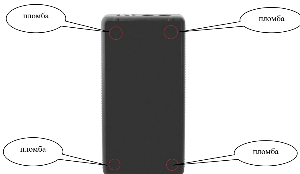
Рисунок 2 - Схема пломбировки от несанкционированного доступа
