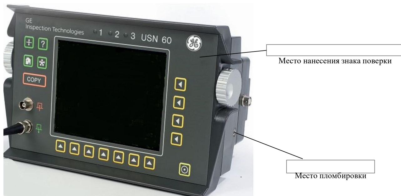
Рисунок 2 – Схема пломбировки от несанкционированного доступа, обозначение места нанесения знака поверки
