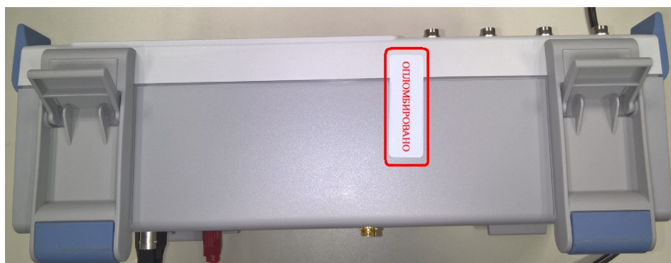
Рисунок 4 – Схема пломбировки от несанкционированного доступа (вид снизу)
